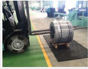
ใช้ปูบนพื้นในโรงงาน เพื่อกระจายน้ำหนักของสินค้าประเภทที่มีน้ำหนักมาก และป้องกันพื้นคอนกรีตร้าว
