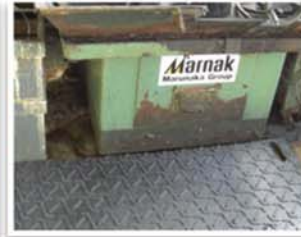
ป้องกันน้ำมันบริเวณรอบเครื่องจักรกันเสียง เป็นฉนวนกันไฟฟ้า
